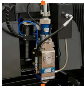
Rezacia hlava s kapacitným senzorom
